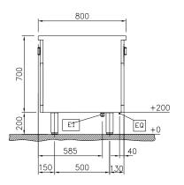
Electrical inlet (power) Equipotential screw
